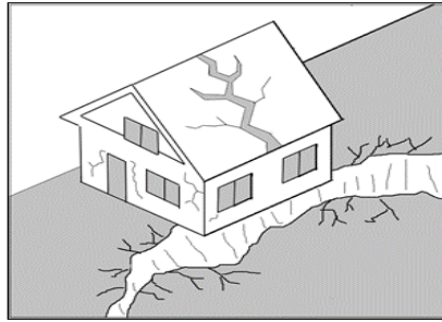
รูปที่ 23 รูปตัวอย่างการทรุดตัวของพื้นดินบริเวณที่ตั้งอาคาร
